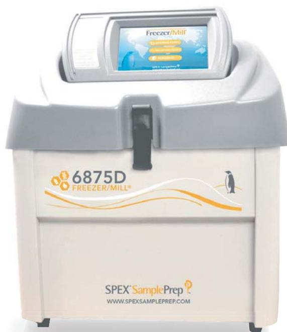
6875D Freezer/Mill® - это высокопроизводительный двухкамерный криогенный измельчитель с собственной термоизолированной ёмкостью с жидким азотом для охлаждения виал с образцами и магнитным приводом для ударного размола. Прибор может обрабатывать образцы в диапазоне масс от 0.1 г до 200 г (по 100 г на каждую размольную камеру).
